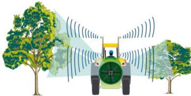
Quando i sensori rilevano l'assenza di vegetazione l'erogazione viene interrotta
